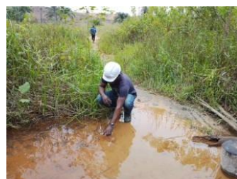
Photo 11 : Prélèvement de l'eau de surface
