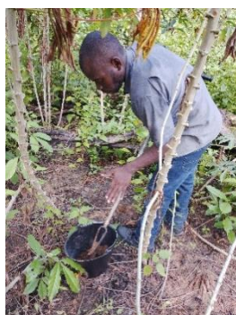
Photo 10 : Prélèvement de sol à l'aide d'une tarière
